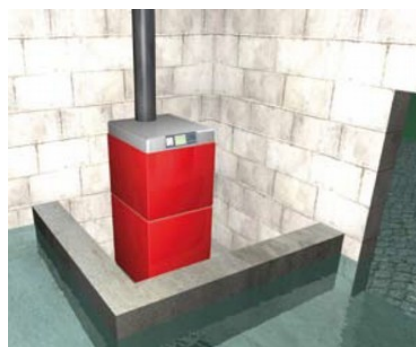
protection par disposition étanche
