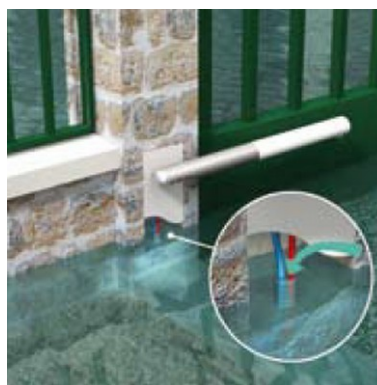
Passage possible de l'eau par les entrées de gaines
