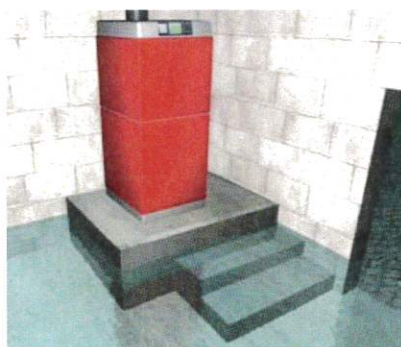
Mise hors d'eau par surélévation
